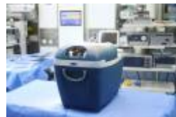
中山一院器官移植团队自主研发的“多器官功能自主修复系统”
